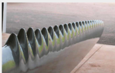
Разработанные WhalePower лопасти ветряных турбин копируют бугорки у края китовых плавников. Это повышает энергоэффективность ветряных турбин. Даже в местах, где ветра нет, отныне можно генерировать его энергию.
